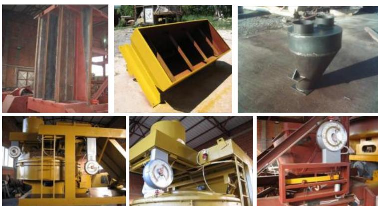
Za vase agregata starog tipa - mehaničke sa analognim očitavanjem vrednosti proizvodimo sve potrebne oslonce, vešalice i španere, i to za sve tipove gde su sistemi korpa-vaga, ili sa posebnim bunkerima za merenje agregata. Kod vase postoji mogućnost prelaska sa analognog očitavanja na digitalno - takozvani «HIBRIDNI SISTEM», gde na mesto glave vase postavljamo sondu za digitalno očitavanje težine. Trajanje remonta uz dobru pripremu je jedan dan, a to je ujedno i priprema vase za baždarenje.
